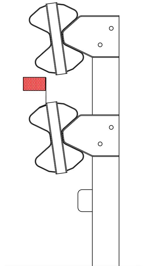
**Delimitatore destro per doppio senso di circolazione con catadiottri 07 X 10 per guardrail realizzato in acciaio zincato nervato 10/10 mm**
