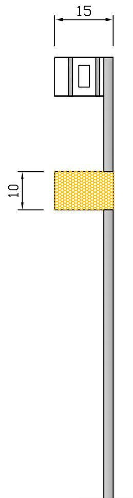
**Delineatore destro con catadiottro 10 X 15 per galleria con marciapiede realizzato in profilato di ferro zincata**
