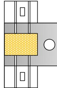
**Delineatore destro con catadiottro 10 X 15 per galleria senza marciapiede e guardrail realizzato in profilato di alluminio 20/10 mm**
