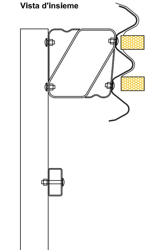
**Delineatore destro con catadiottro 07 X 10 per guardrail**
