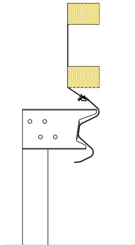
**Delineatore destro con catadiottro 07 X 10 per guardrail
