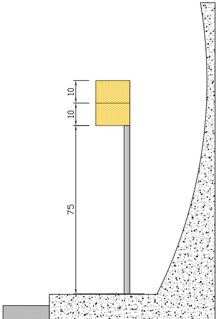
**Delineatore sinistro con catadiottro 10 X 15 per galleria senza marciapiede e guardrail realizzato in profilato di alluminio**
