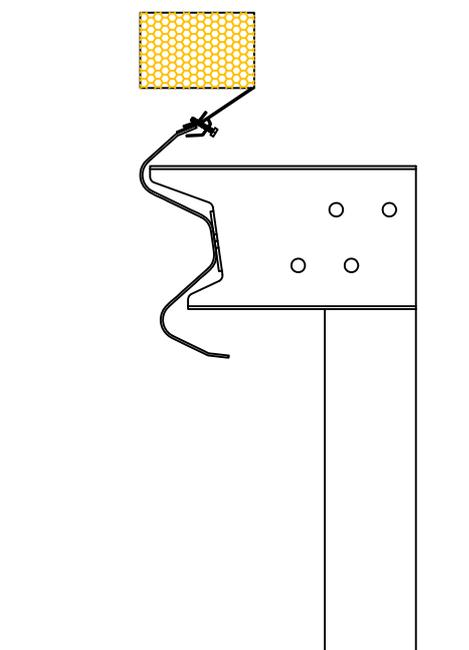
**Delimitatore destro per doppio senso di circolazione con catadiottri 07 X 10 per guardrail realizzato in acciaio zincato nervato 10/10 mm**
