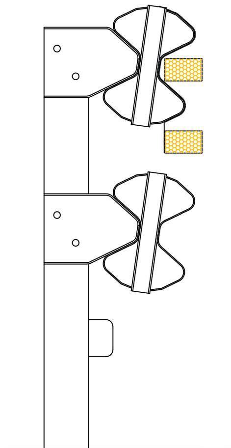
**Delineatore destro con catadiottro 07 X 10 per guardrail
