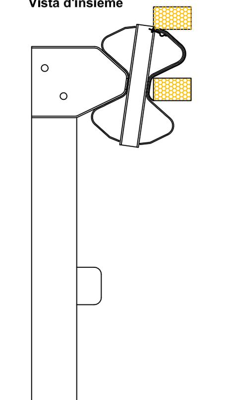
**Delineatore destro con catadiottro 07 X 10 per guardrail
