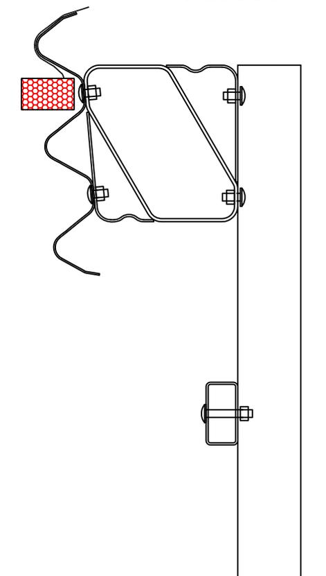
**Delimitatore destro per doppio senso di circolazione con catadiottri 07 X 10 per guardrail realizzato in acciaio zincato nervato 10/10 mm**
