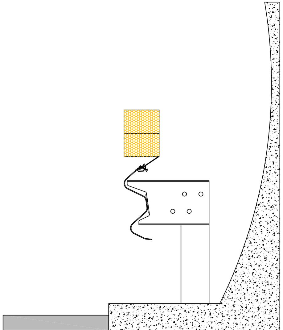
**Delineatore sinistro con catadiottro 10 X 15 per galleria con marciapiede realizzato in profilato di ferro zincata**
